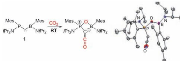
**Immer auf die Kleinen:** Das stabile Boryl(phosphinyl)carben **1** kann kleine organische Dioxidmoleküle spalten. Mit  $\text{CO}_2$  und  $\text{SO}_2$  ergibt **1** die Phospha-cumulen-Ylide  $[\text{Mes}(\text{iPr}_2\text{N})\text{B}-\text{O}-\text{P}(\text{CCO})-$
