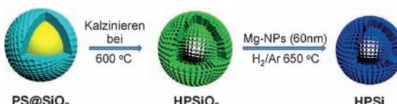
**Löchrige Angelegenheit:** Ein Nanokomposit aus hohlem porösem (HP) Silizium und Silber-Nanopartikeln (NPs) wurde hergestellt (siehe Schema; PS = Polystyrol). Das freie Volumen in der HPSi-Struktur fängt effektiv die Volumenände-
